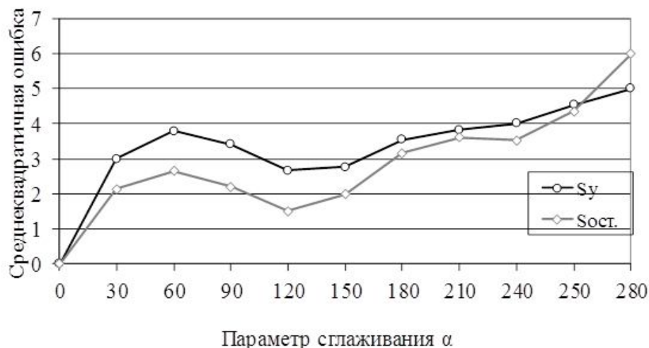
Рис. 2. Зависимость среднеквадратичной ошибки от параметра сглаживания \alpha для модели первого реактора
