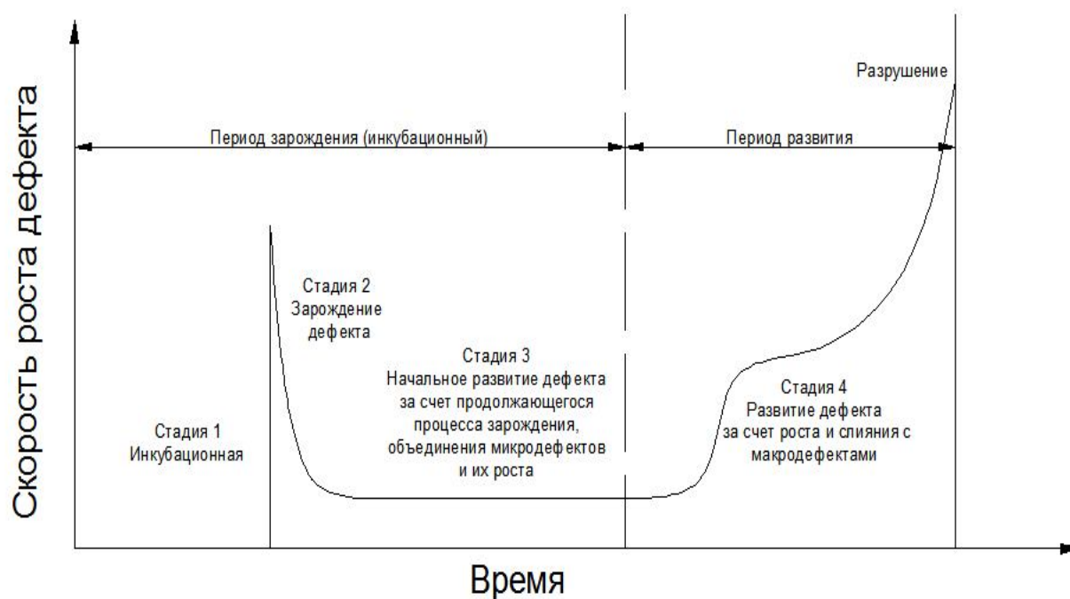
Рис. 2. Изменение скорости роста дефекта КРН
