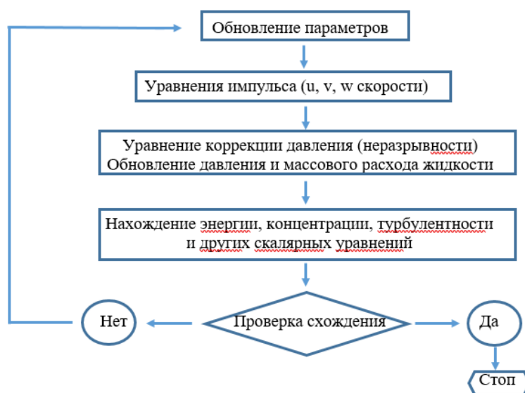
Рис. 3. Алгоритм Pressure-Based Solver
