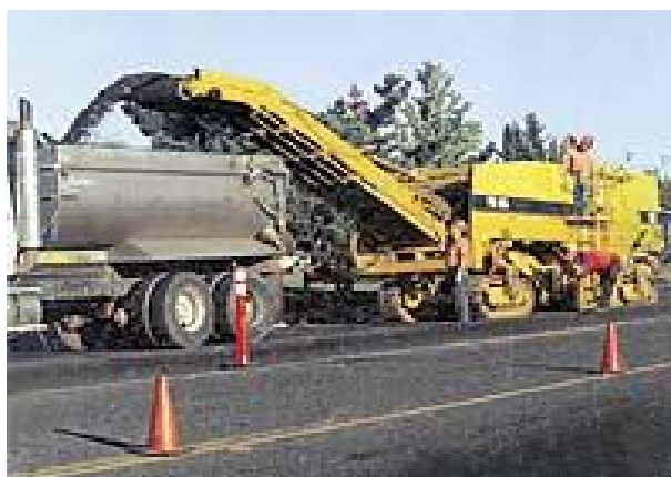
Рис. 5. Дорожная фреза фирмы Caterpillar PM-565B
