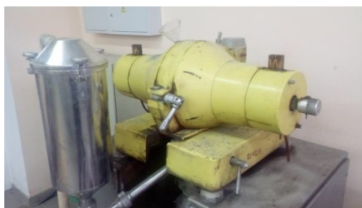
Рис. 3. Общий вид лабораторного дезинтегратора
