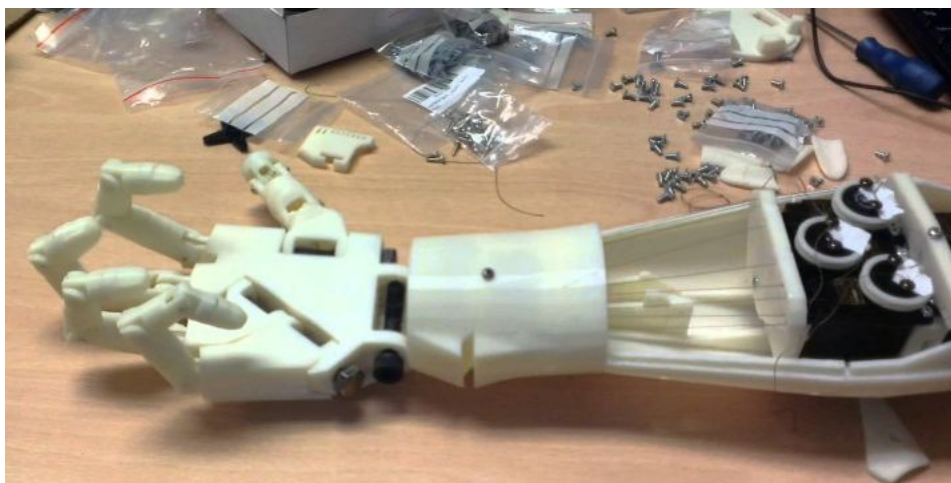
Рис. 2. Бионическая рука, напечатанная на 3D принтере
