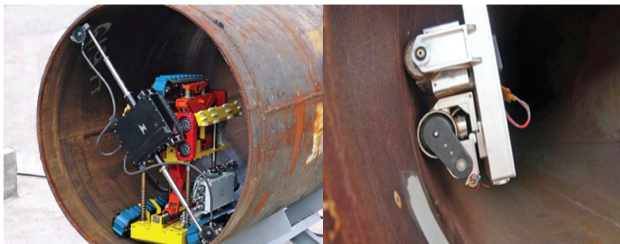
Рис. 3. Роботизированные средства диагностики а) робот-трактор ЗАО «КТПИ «Газпроект»; б) робот-сканер на магнитных колесах ЗАО «Интроскан-технолоджи».
