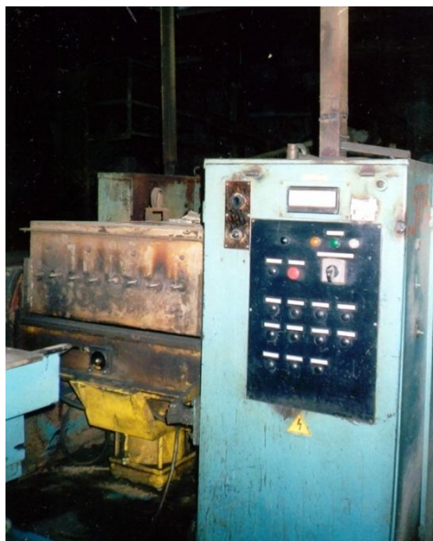
Рис. 1. Формовочная машина марки 51713, дооснащенная прессовой плитой в бункере
