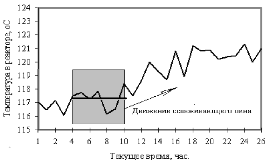
Рис. 4. Усреднение измеренных данных с помощью алгоритма скользящего среднего
