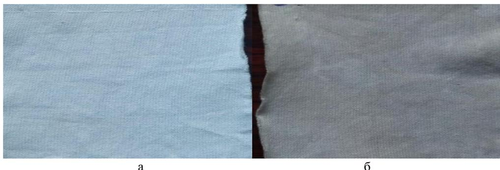
**Рис. 3.** Фотографии отбеленного трикотажа после обработки растворами КМК и  $\text{Ag}^+\text{КМК}^-$ , УФ-облучения и сушки: а – в растворе  $\text{NaКМК}$  – 0,4%; б – в растворе  $\text{NaКМК}$  – 0,4%,  $\text{AgNO}_3$  – 0,25%;
