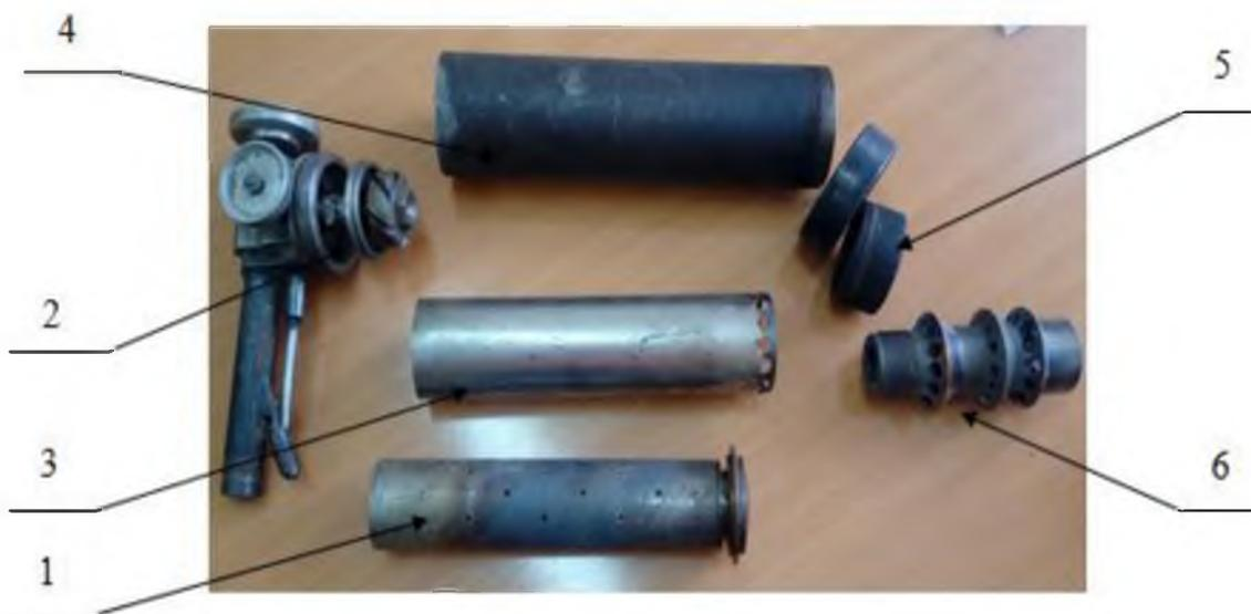
1 – камера сгорания с соплом Лавала, 2 – рукоятка с каналам подачи топливных компонентов, 3 – промежуточный кожух, 4 – наружный кожух, 5 – гайки соединительные, 6 – насадка
