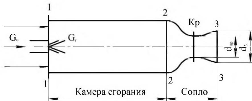
Рисунок 3.5 – К тепловому и газодинамическому расчету реактивной горелки
