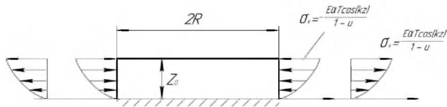
Рисунок 3.19 – Модель напряженного равновесного состояния прогретого слоя
