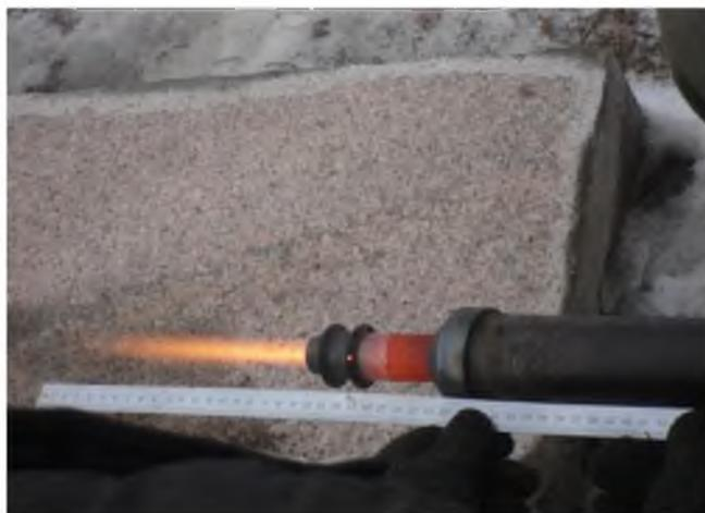
Рисунок 4.3 – Процесс выведения факела горелки на рабочий режим работы
