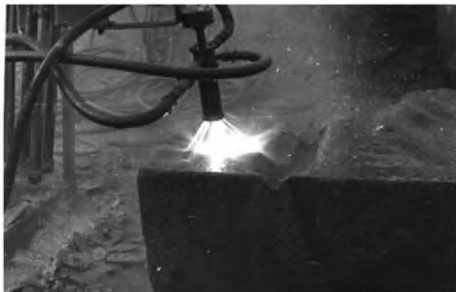
Рисунок 3.21 – Прорезание канавок при грубой обработке
