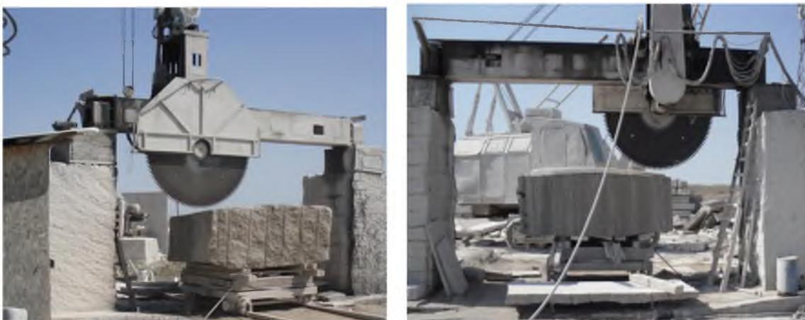
Рисунок 1.1 – Процесс распиловки гранитного блока дисковой алмазной пилой
