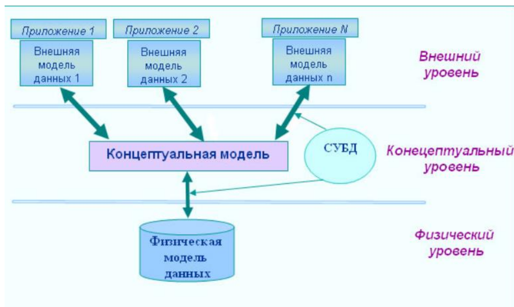
2.6-сурет – ANSI-мен ұсынылған мәліметтер базасын басқару жүйесінің үш деңгейлі моделі
