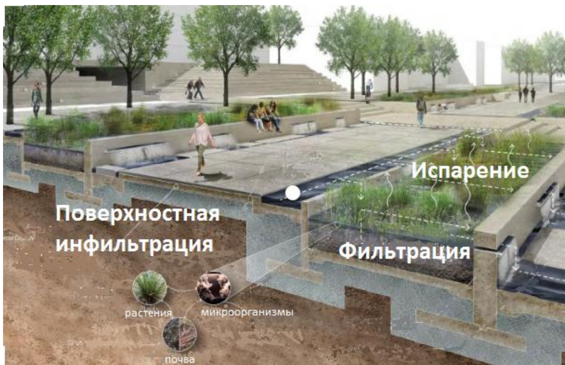
Рисунок 21. Процессы, происходящие с ливневыми водами в дождевом парке
