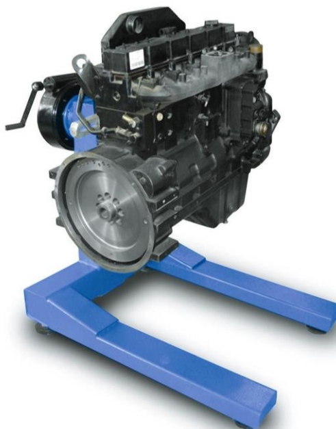
3.2 Сурет – Жеңіл және орта санатты Р1250 автомобиль қозғалтқыштарын бөлшектеуге-құрастыруға арналған әмбебап стенд
