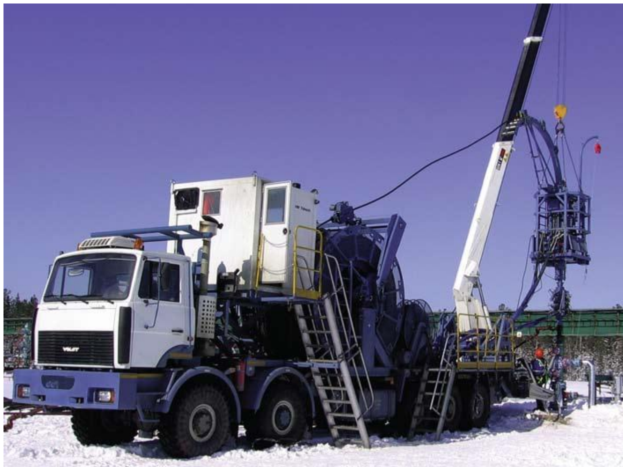
5 Сурет – МК20Т қондырғысы пайдалану дайындық жағдайында
