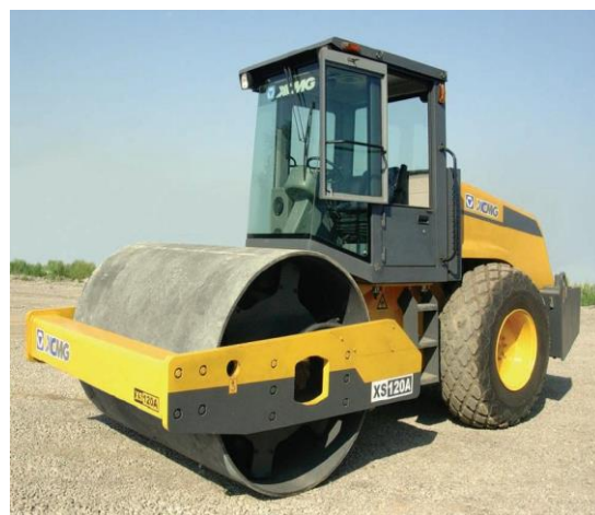
Рисунок 1.11 - Катки комбинированного действия
