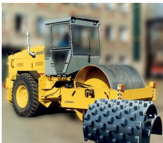
Рисунок 1.5 - Самоходный дорожный каток с вариантами трансформации гладковальцового катка в кулачковый и наоборот
