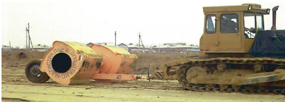
Рисунок 1.10 - Прицепной ударный каток ДМ-7 с некруглыми вальцами
