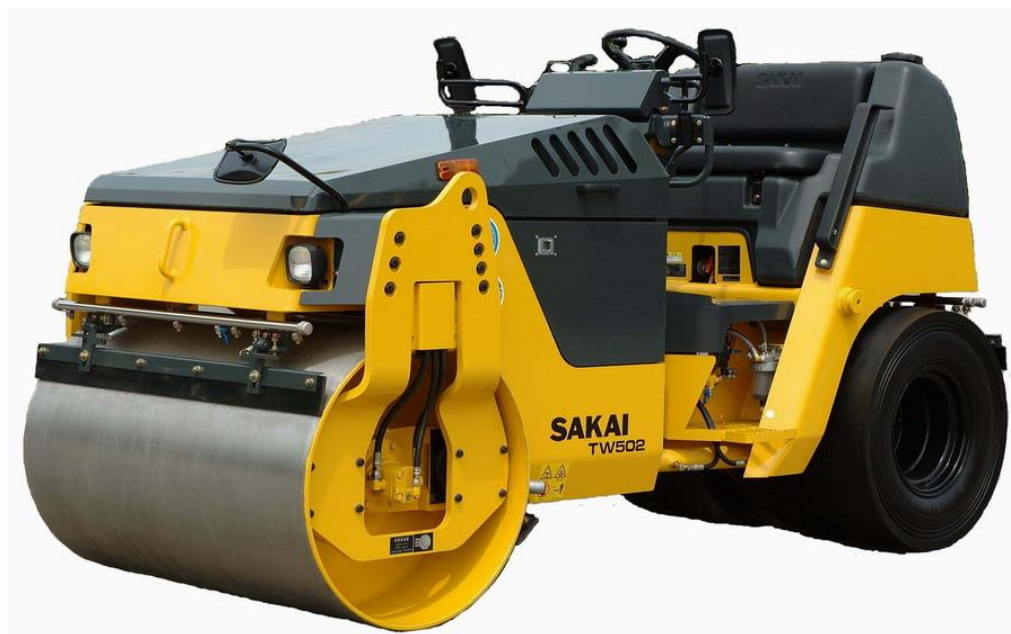
Рисунок 1.13 - Комбинированный каток SAKAI TW 502 включающий в себя передний гладковальцовый вибровалец и задние гладкие пневмошины
