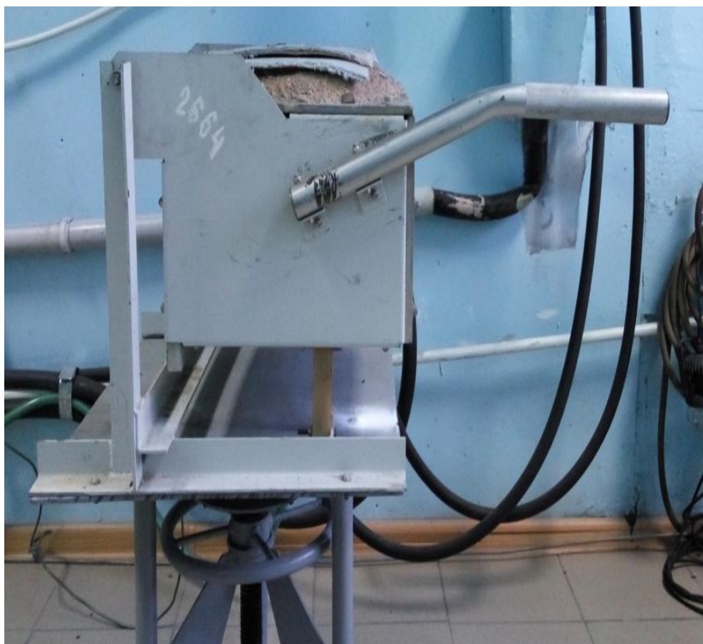
6 Сурет – Индукционды балқыту пеші ППИ-0,005
