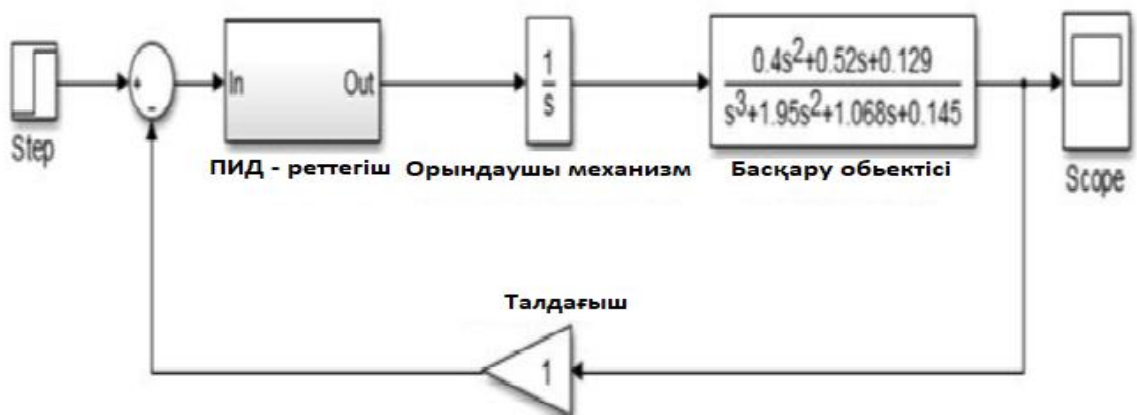
7 Сурет - ПИД - реттеуіші бар тұйық жүйенің блокты диаграммасы
