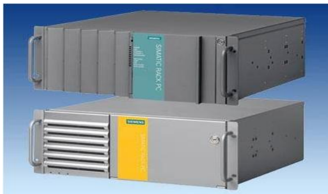
2.4 Сурет - Өндірістік компьютер SIMATIC Rack PC IL43
