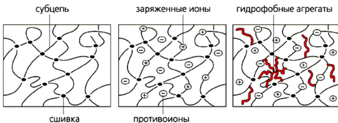
Рисунок 4. Схема строения трех форм полимерного геля. Слева направо: незаряженная сетка, полиэлектролитная (в ней за счет диссоциации ионогенных групп в водной среде образуются заряженные звенья на полимерных цепях и низкомолекулярные противоионы) и сетка с гидрофобными группами, ассоциирующими друг с другом в водном растворе.
