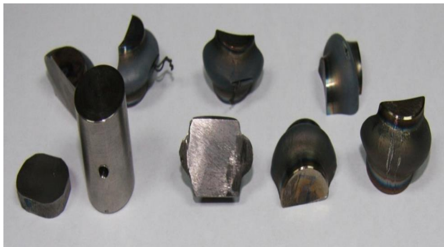
Рисунок 2.5 – Внешний вид испытанных образцов после сжатия
