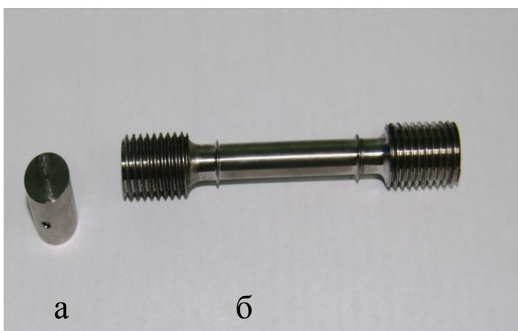
Рисунок 2.1 – Внешний вид титановых образцов для испытаний на сжатие (а) и растяжение (б)
