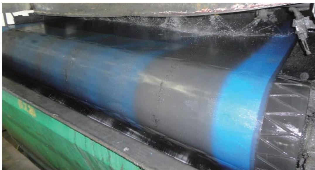
Рисунок 12 – Улавливание угольной мелочи из хвостов выщелачивания
