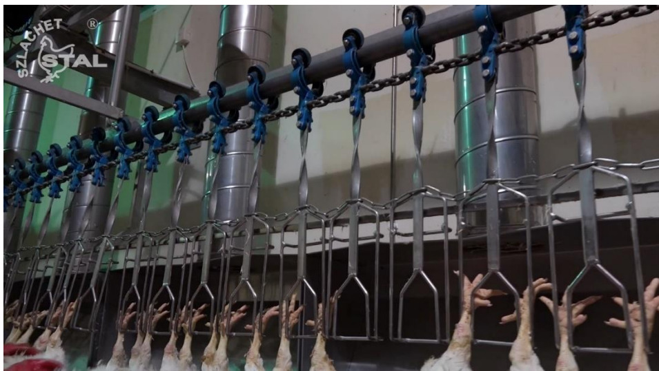
1.2-сурет - Көлденең конвейердің сыртқы көрінісі
