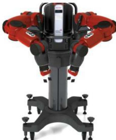
Рисунок 5 – Манипулятор, обладающей ангулярной системой координат
