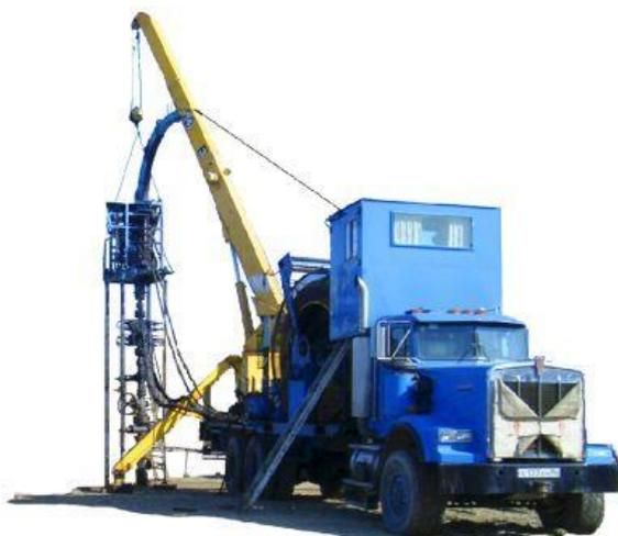
Рисунок 2.2 - Внешний вид установки колтюбинга
