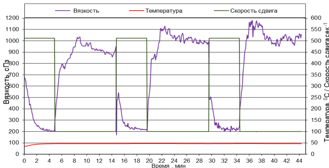
Сурет 3.3 – Мұнай – газ технологиясы бойынша аз тұтқыр гельді қолдану арқылы ҚСЖ процесін жүргізу графигі. Айдалған пропанттың көлемі – 12 т, пропанттың орташа концентрациясы – 350 кг / м 3 қоспа
