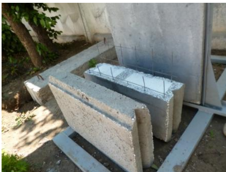
Полистиролбетон панель в разрезе
