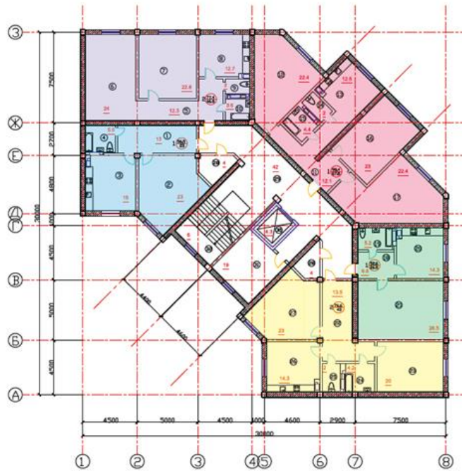
План типового этажа угловой секций жилого дома
