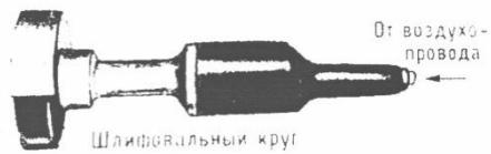
Рисунок 10 – Шлифовальная ручная машина пневматическая.
