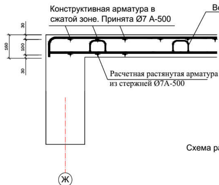
1-1 Узел соединения плиты и несущей стены.
