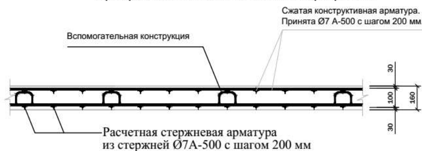
2-2 Армирование монолитное плиты перекрытия.
