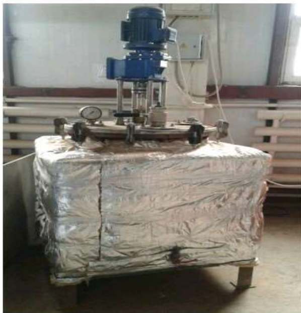
3 Сурет - Мүйіз бен тұяқтардан әзірленетін кератинды көбік концентратын гидролиздеу үшін дайындалған реактордың жалпы көрінісі
