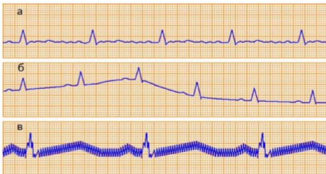
3.1 сурет — MatLAB жүйесінде алынған ЭКГ тіркеу кезінде туындайтын: а-бұлшықет треморымен негізделген кедергі (дұрыс емес жиі тербелістер көрінеді); б– терімен нашар байланыс нәтижесінде дрейф сызықтары; в – 50 Гц жиілігімен дұрыс тербеліс түріндегі желілік кедергілер.
