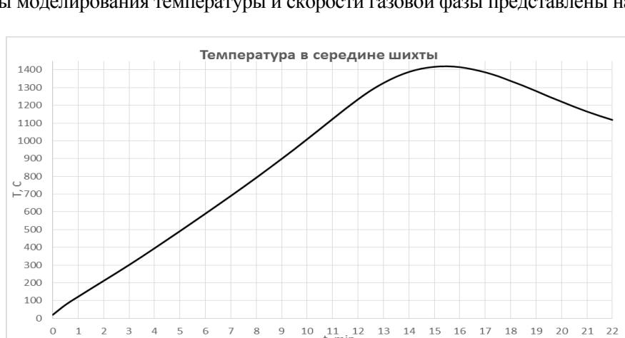
Рис. 1. Температура шихты в середине аглошихты
