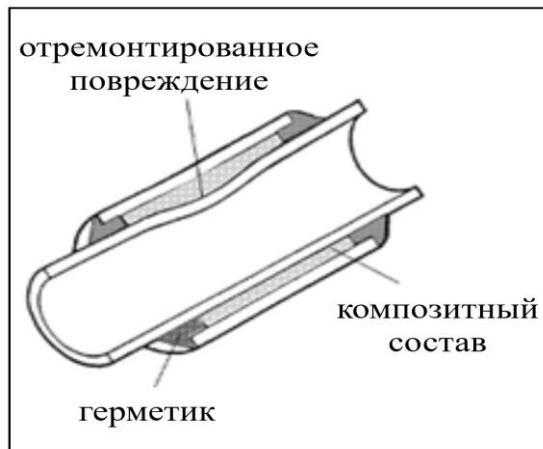
Рис.2. Композитная муфта
