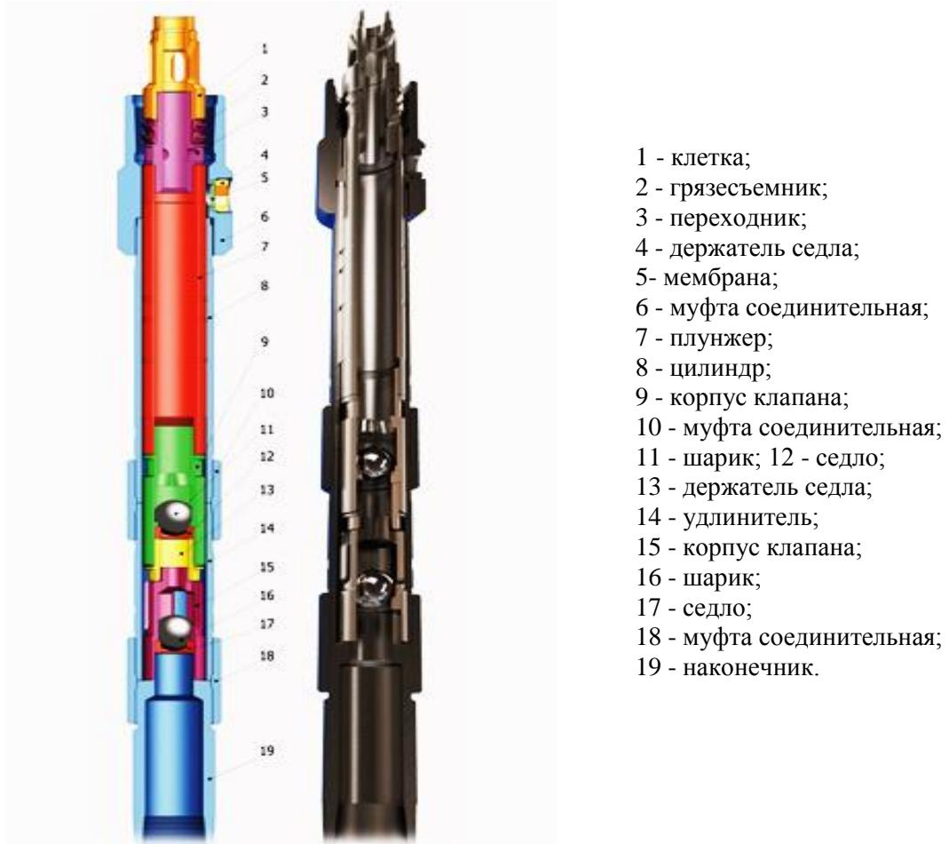
Рис.1. Типовая конструкция штангового глубинного насоса
