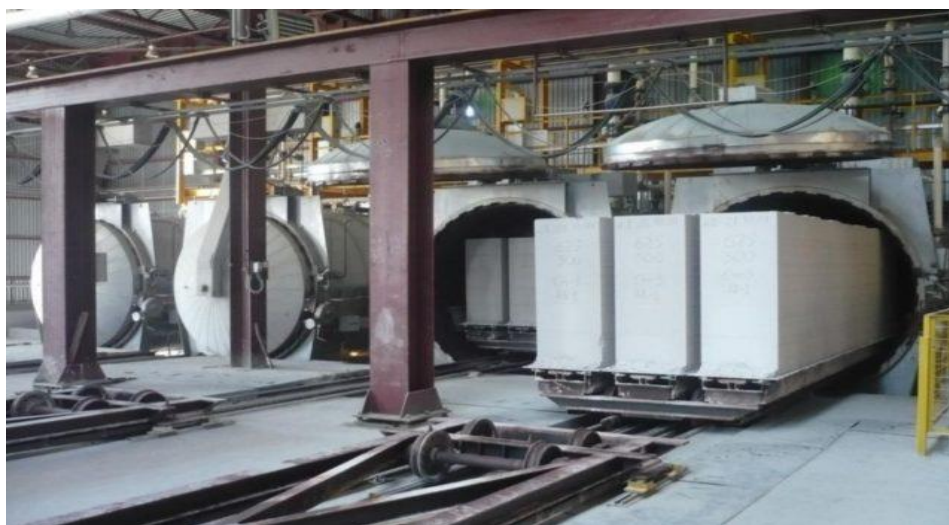
1 Сурет – Автоклактағы газды бетон
