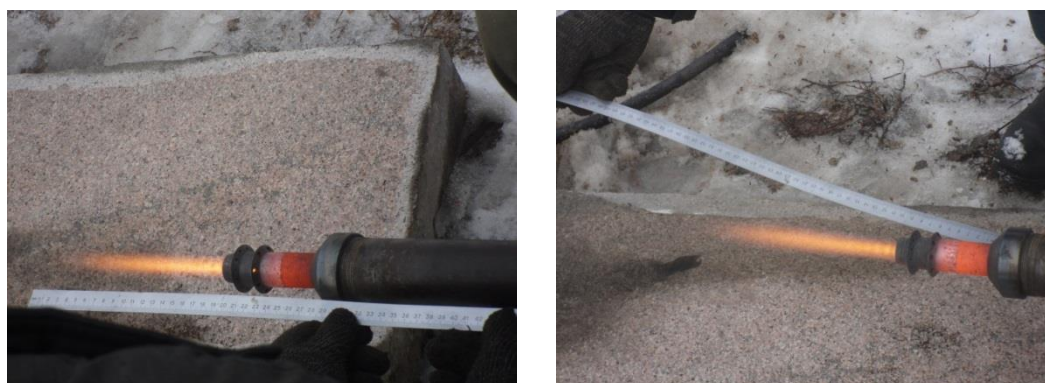
Рис. 1.2. Определение длины факела горелки терморезака
