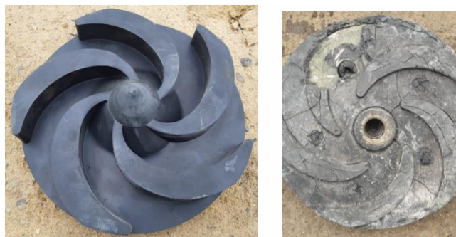
Рис. 1. Гуммированное рабочее колесо насоса до и после эксплуатации
