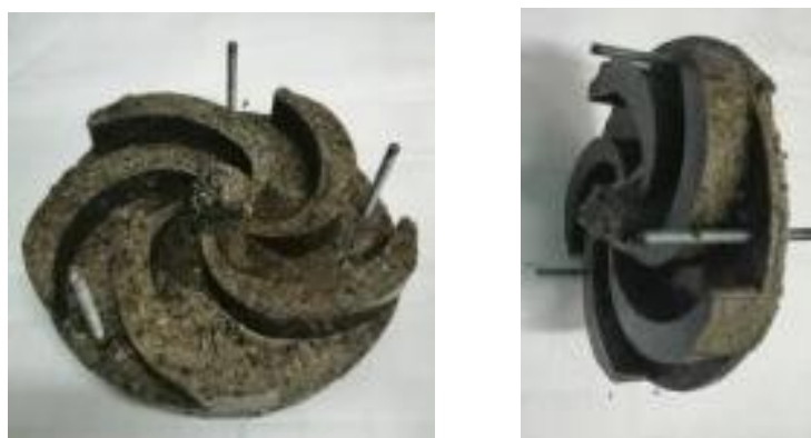
Рис. 9. Рабочее колесо насоса облицованное полимербетоном
