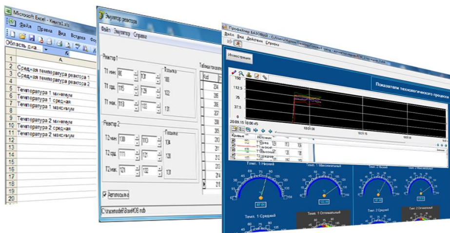
Рис. 1. Рабочие окна проекта в SCADA Trace Mode.
