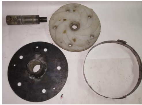
Рис. 7. Литейный комплект для облицовки рабочего колеса
