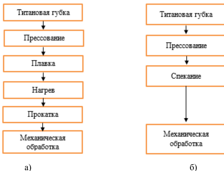
Рис. 1. Технологическая схема получения деталей по традиционной литейной технологии (а) и порошковой (б).
