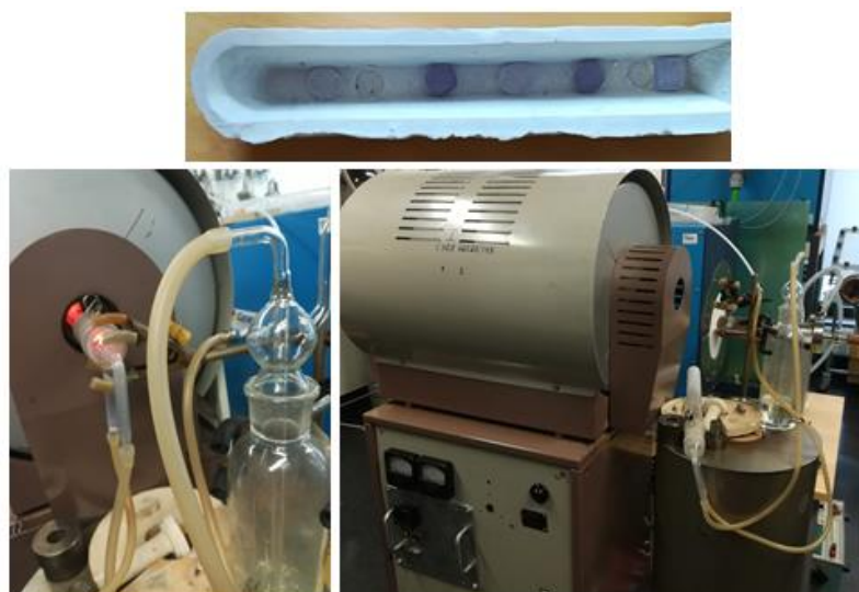
Рис. 2. Установка для термического отжига монокристалла MgO
