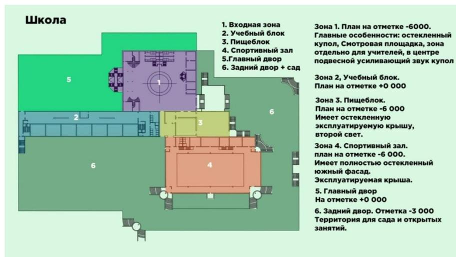
Рисунок 31. Экспликация помещений
