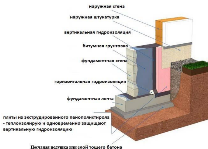
Рисунок 29. Гидроизоляция фундамента
