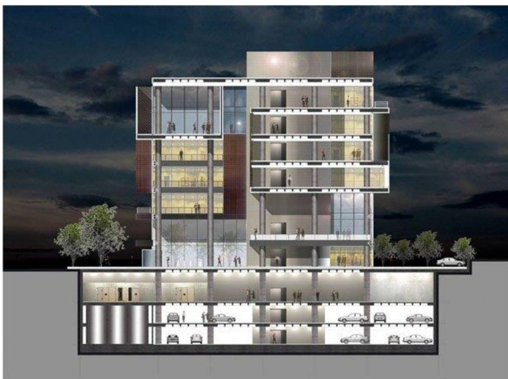
Рисунок 10. Разрез Dogan Media Center
