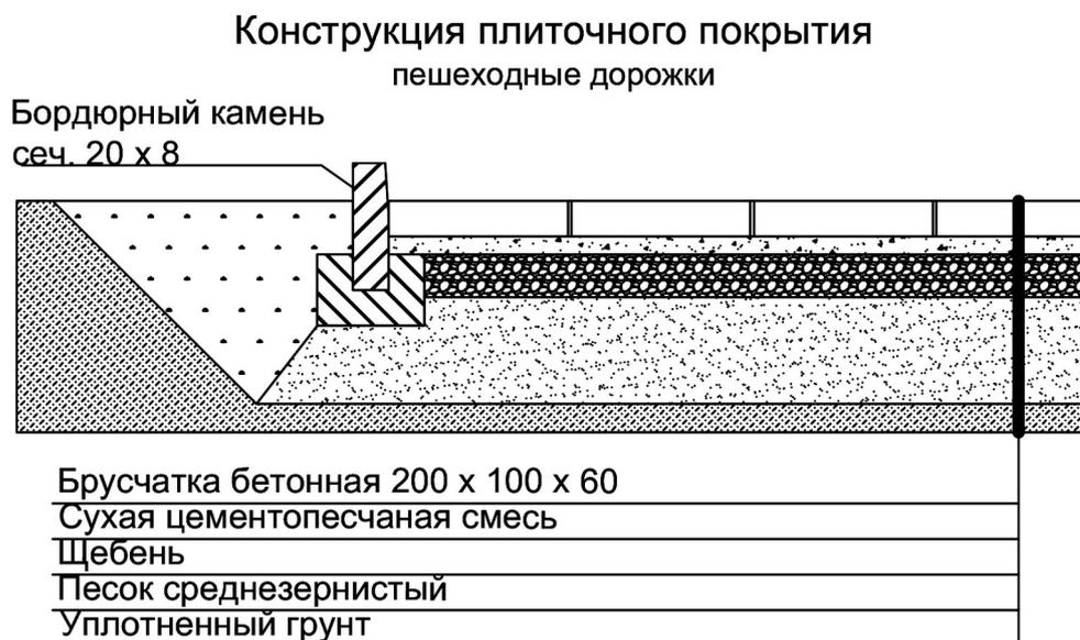
Рисунок 14. Узел плиточного покрытия
