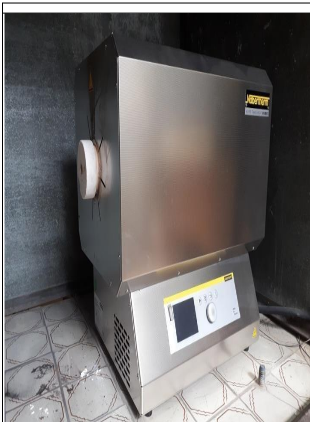
А.7 Сурет- Nabertherm RHTC 80- 230/15/B410» күйдіру-балқыту құбырлы пеші
