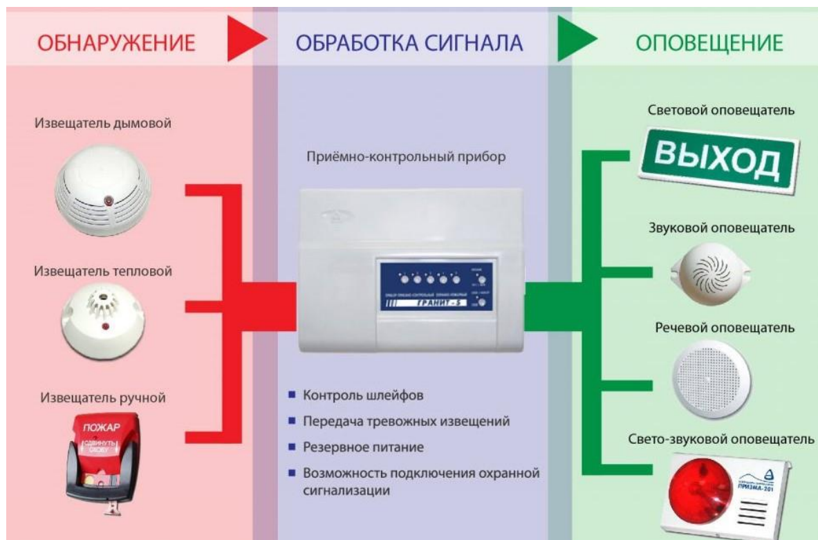
Рисунок В – Принцип работы АУПС
