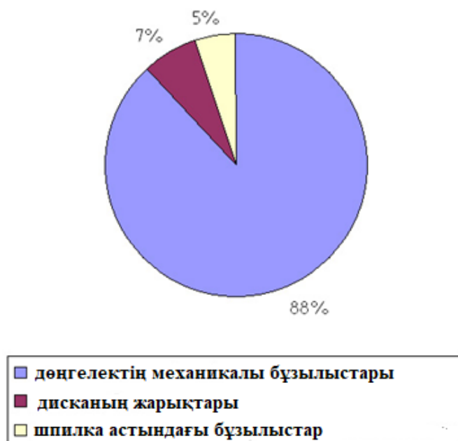
1.3-сурет - Автобустың дөңгелектерінің бұзылу себептері
