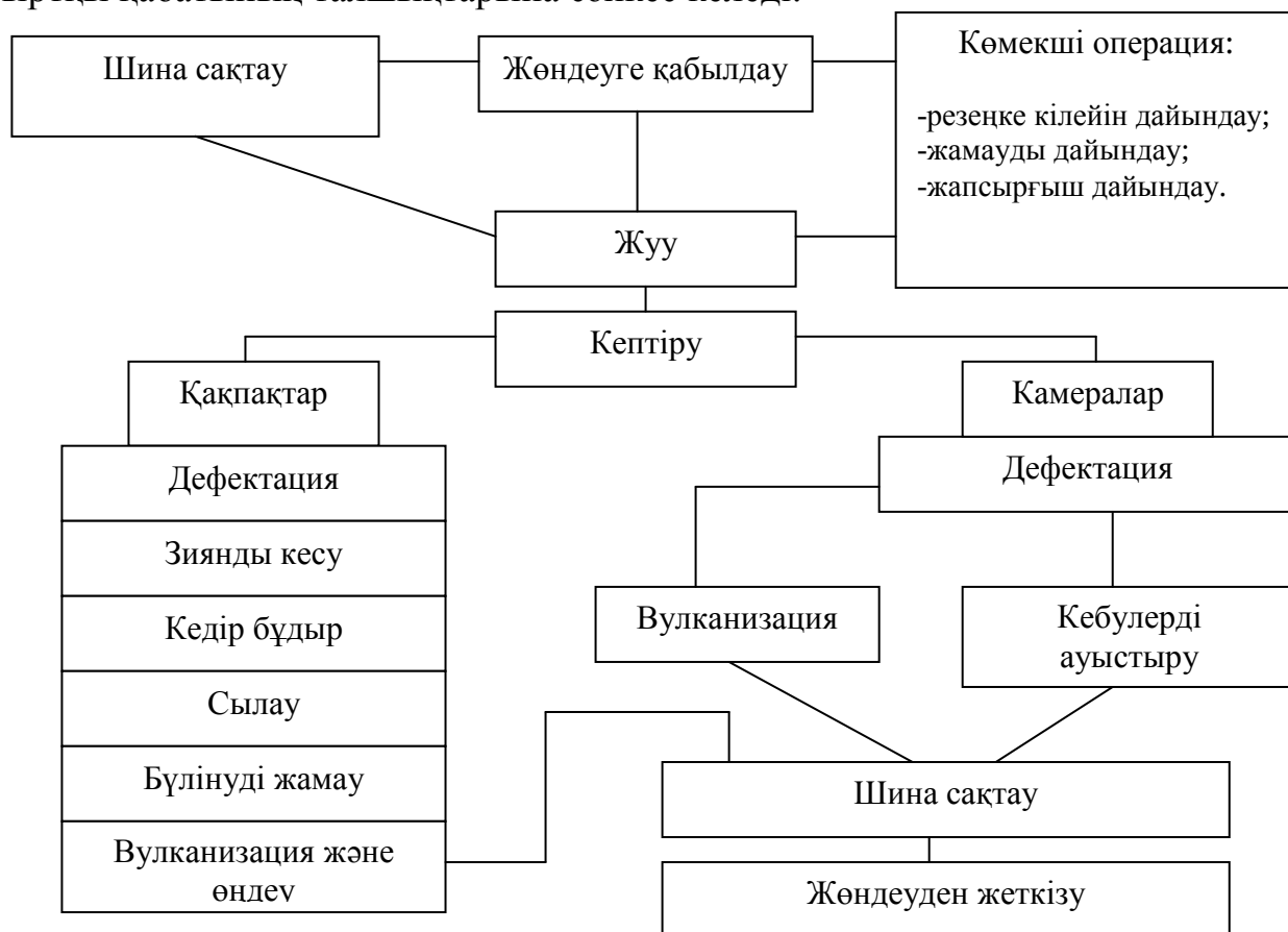
2.2 – сурет - Шиналардың жергілікті бүлінуін жөндеудің технологиялық процесінің сызбасы
