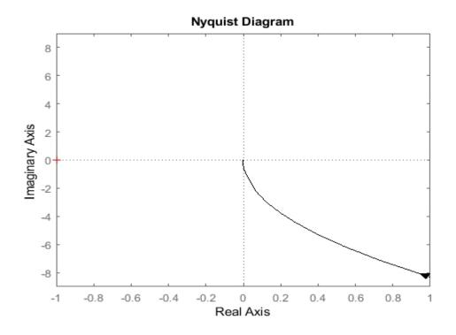
Рисунок 2.6 – АФЧХ разомкнутой системы
