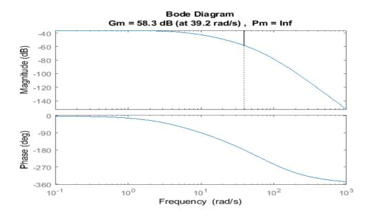
Рисунок 2.19 – АЧХ и ФЧХ системы с регулятором
