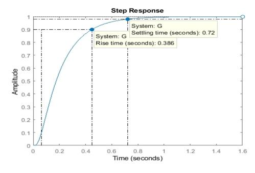
Рисунок 2.18 – Переходная характеристика с регулятором
