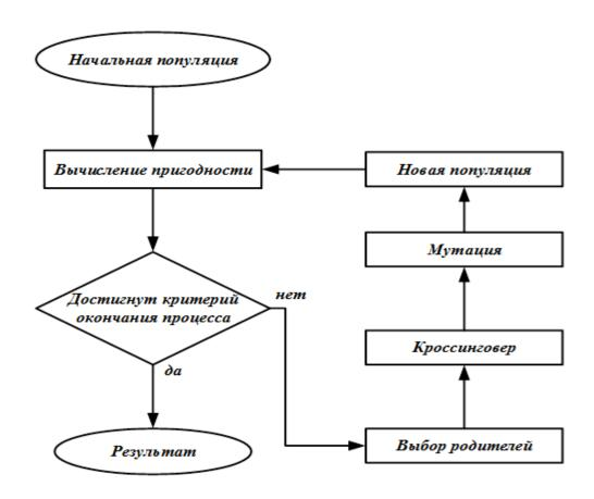
Рисунок 2.2 – Схема простого генетического алгоритма
