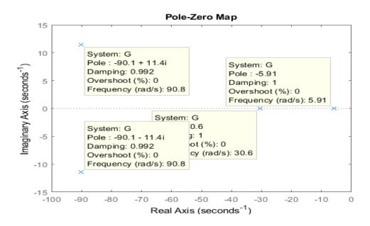
Рисунок 2.17 – Полюса системы с регулятором
