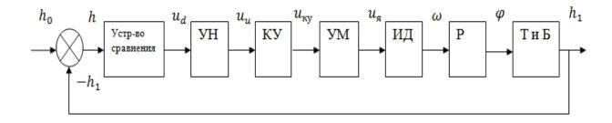
Рисунок 2.4 – Функциональная схема замкнутой системы
