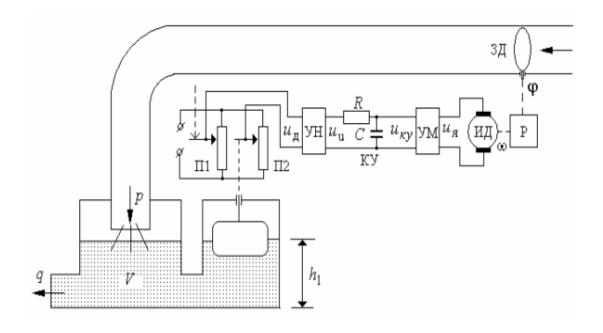
Рисунок 2.3 – Схема регулирования уровня жидкости в открытом баке
