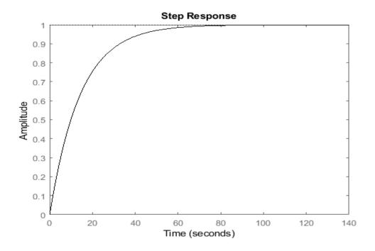
Рисунок 2.5 – Переходная характеристика объекта управления
