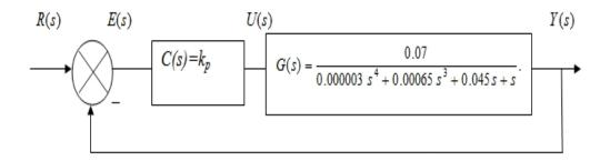
Рисунок 2.13 – Структурная схема объекта управления
