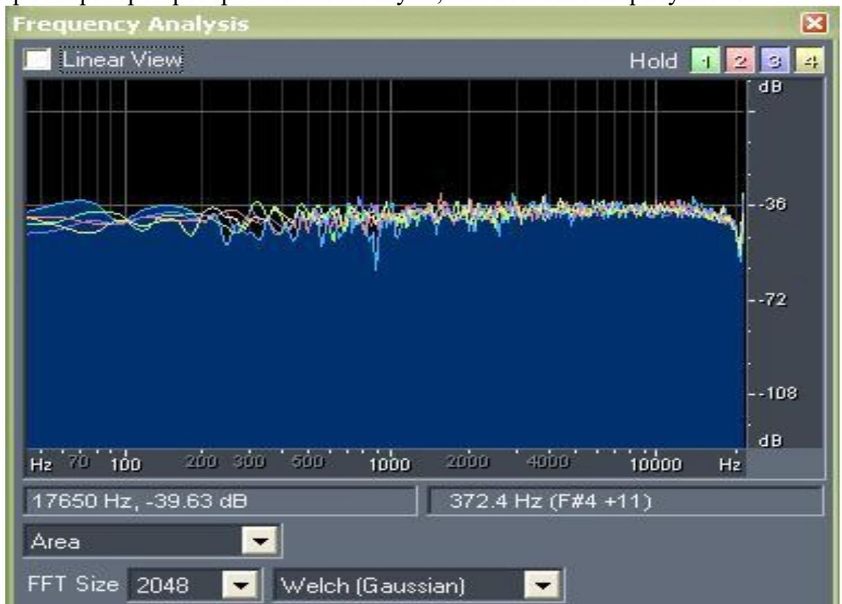
Рисунок 4 -Частотный диапазон ГПЗ
