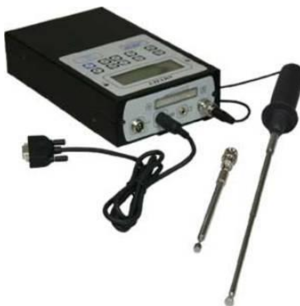
Рисунок 2.4 – Электромагнитный обнаружитель видеокамер «Амулет»
