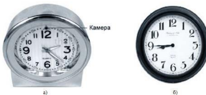
Рисунок 1.6 – Система скрытой видеозаписи на базе цифрового видеорекодера, встроенная в настольные (а) и настенные (б) часы.
