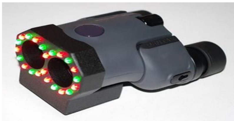
Рисунок 2.11 – Прибор для обнаружения скрытых видеокамер «Оптик-2»
