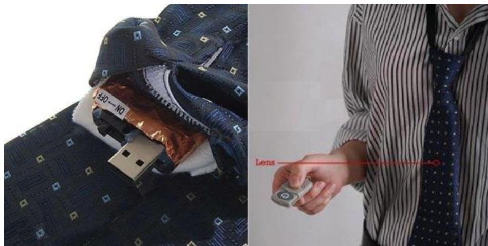
Рисунок 1.8 – Видеокамера «pin-hole», встроенная в галстук
