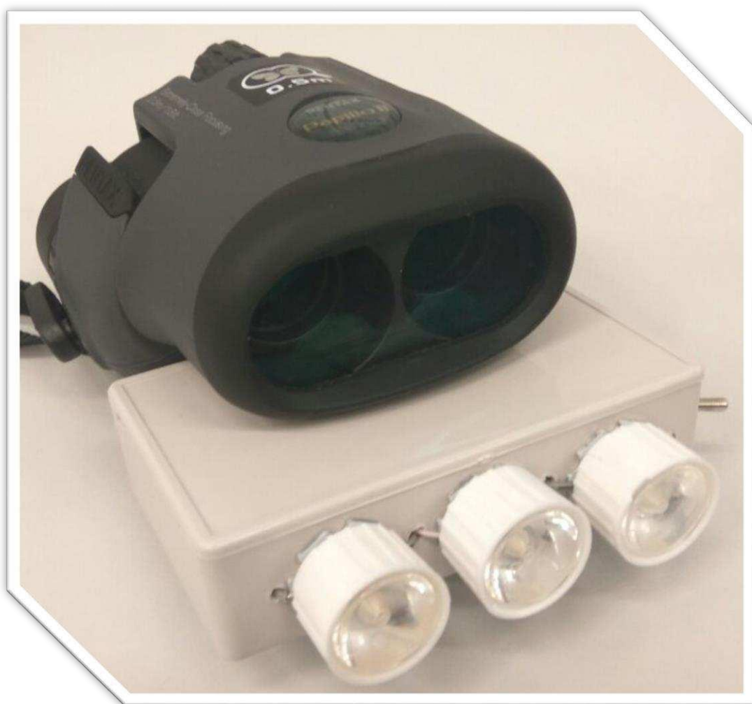
Прототип-1. Устройство обнаружения скрытых фото- и видеокамер методом оптической локации
