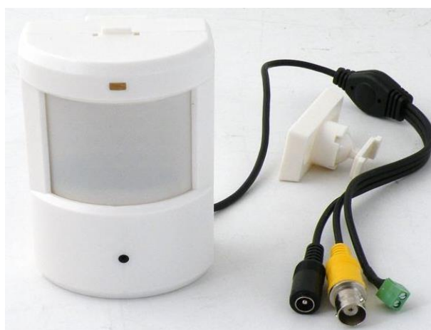
Рисунок 1.7 – Видеокамеры «pin-hole», встроенная в пассивный инфракрасный датчик.
