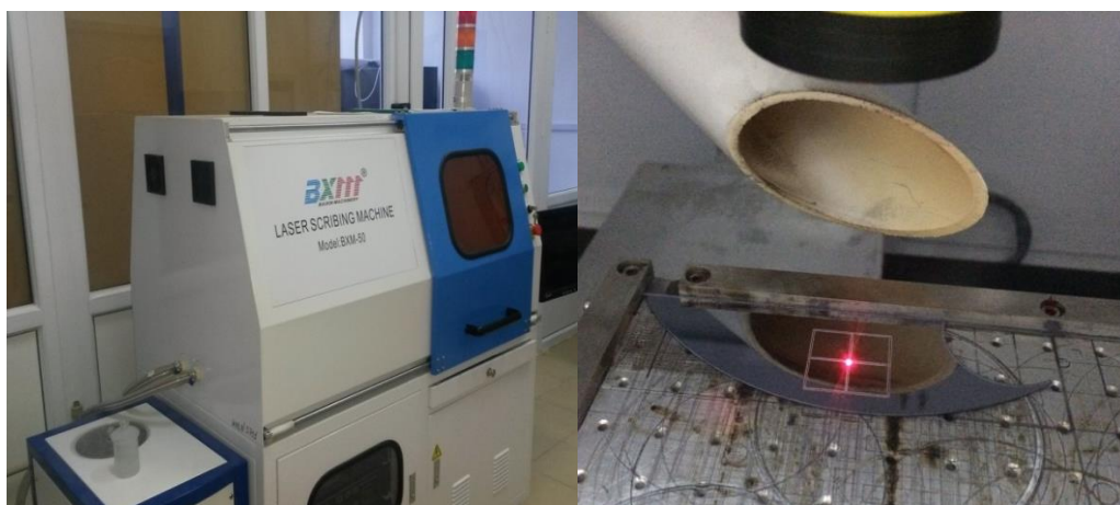
7 Сурет - Laser Scribing machine (Model: BXM-50) қондырғысы арқылы кремний төсеніштерін кесу
