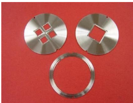
5 Сурет - Үлгі ұстағыш қондырғысы үшін жиектеме мысалы
