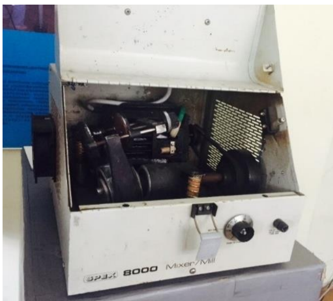
2 Сурет – Вольфрам карбидті цилиндрі мен шарлары бар «SPEX8000» шар диірмені
