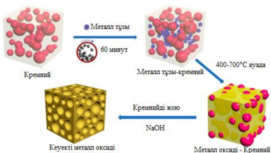
1 Сурет – Наноқұю механохимиялық әдісінің орындалу процесі
