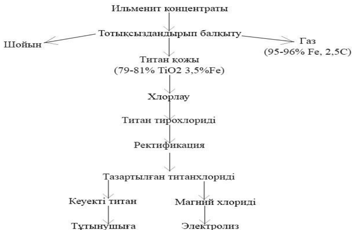
1 сурет – Ильменит концентратын өндеу технологиясы
