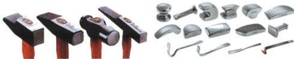
Рисунок 2 - Набор инструментов для удаления вмятин
