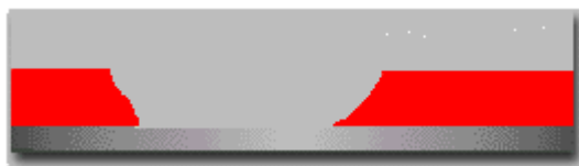
Рисунок 7 – Вид скола краски до ремонта в разрезе
