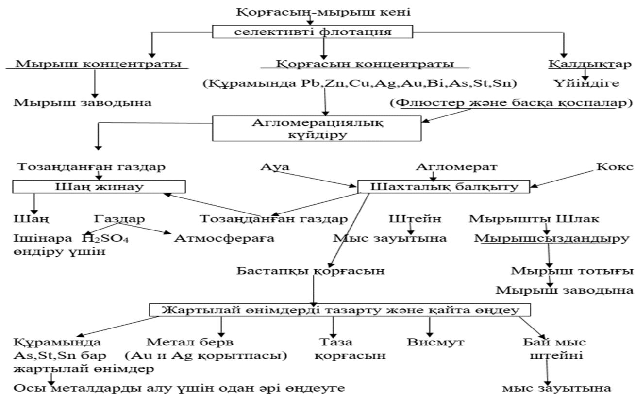
1.1 Сурет – Қорғасынның құнды құрауыштарын кешенді пайдалану кезінде шахталық қалпына келтіру балқыту әдісімен қорғасынды алу
