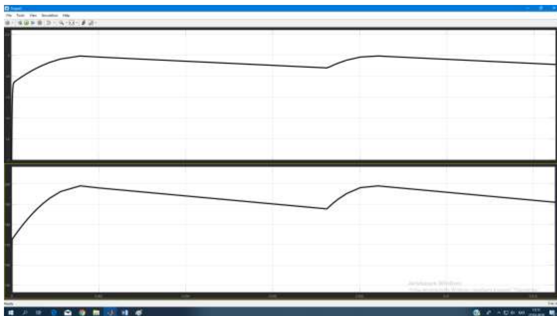
22 Сурет –MatLab ортасындағы үш фазалы RL жүктемелі ( R=10\Omega , L=0.001\text{Гн} ) және С фильтрлі ( 0.01\text{Ф} ) көпірдің шығыс мәндері.
