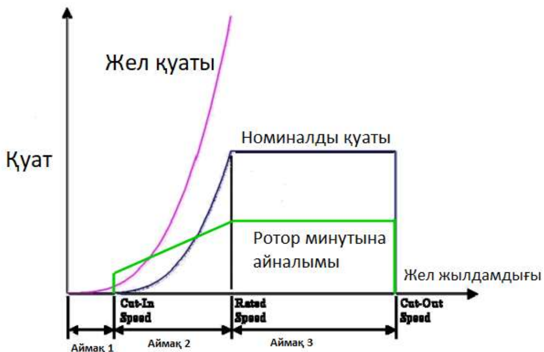
2 Сурет – Жел генератор қуатының жел жылдамдығына тәуелділік графигі
