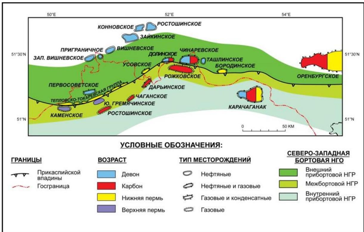
Рисунок 2.3 – Схема нефтегазоносности Северной бортовой зоны [3]
