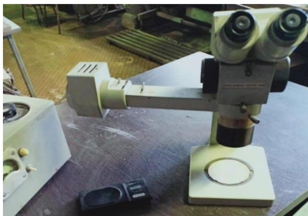
Рисунок 2.12 – Оптический микроскоп для исследования в отраженном свете
