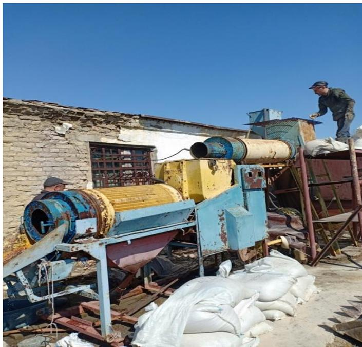
Рисунок 2.8 – Технологический процесс дезинтеграции и классификации в скруббер – бутаре материала золошлаковых отходов экибастузских углей
