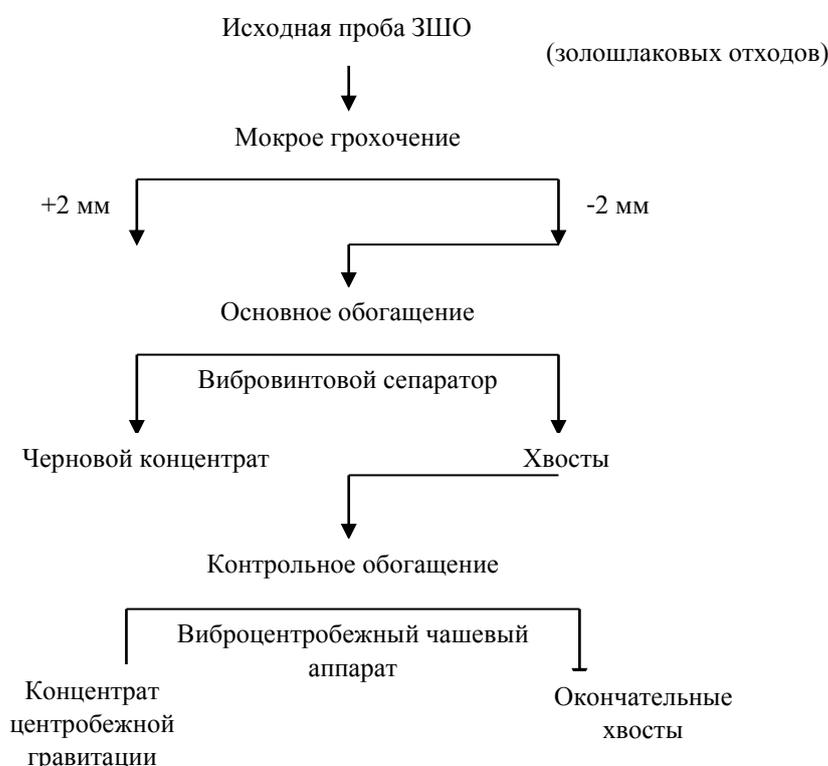
Рисунок 2.1 – Базовая технологическая схема применявшаяся при гравитационном обогащении материала золошлаковых отходов экибастузских углей
