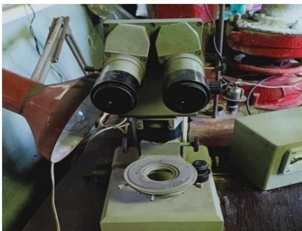
Рисунок 2.11 – Оптический микроскоп – исследования в проходящем и косом освещении
