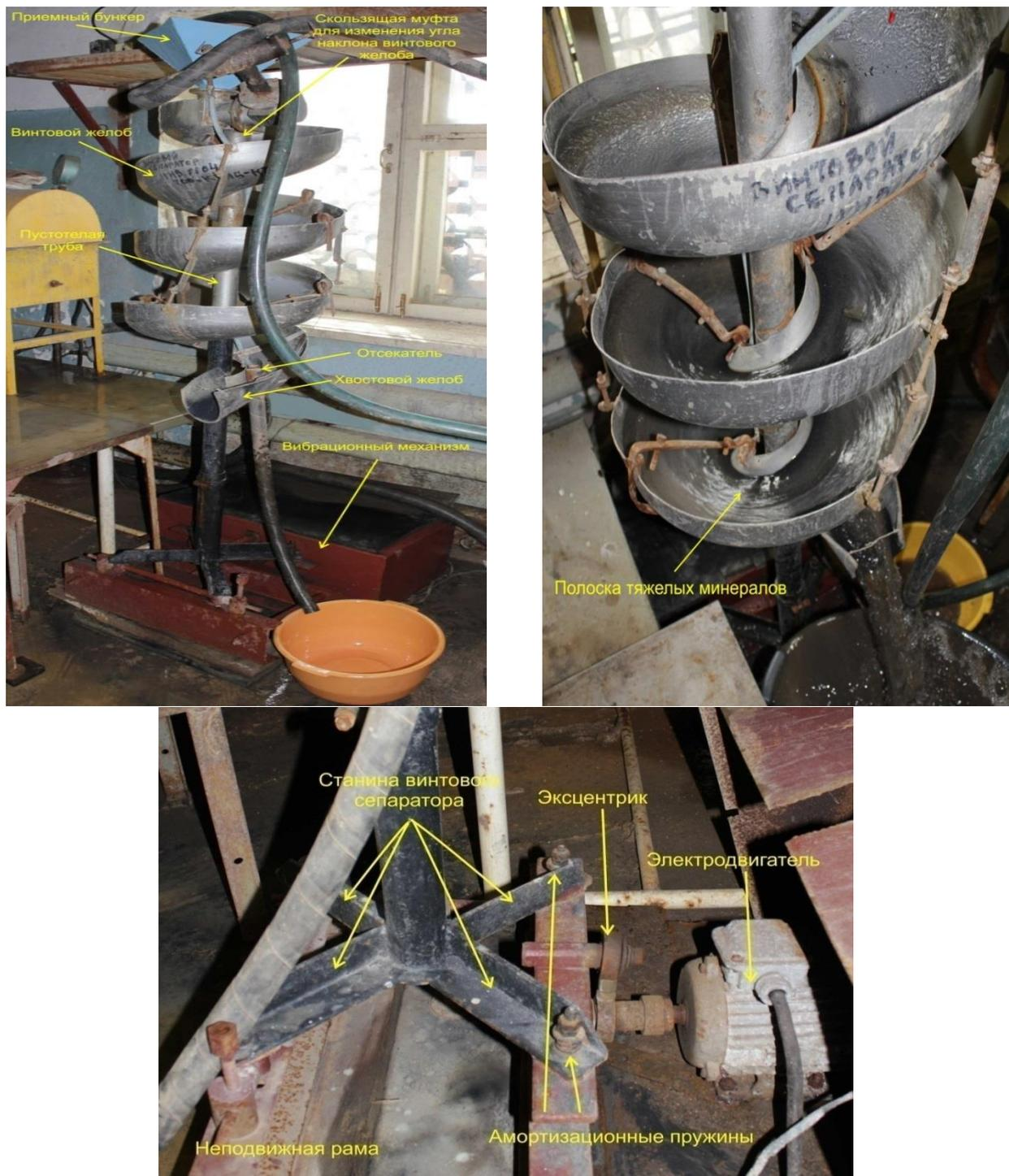
Рисунок 2.3 – Серийно выпускаемый винтовой сепаратор, дополненный вибрационным механизмом, использовавшийся при проведении технологических испытаний золошлаковых отходов экибастузских углей.
