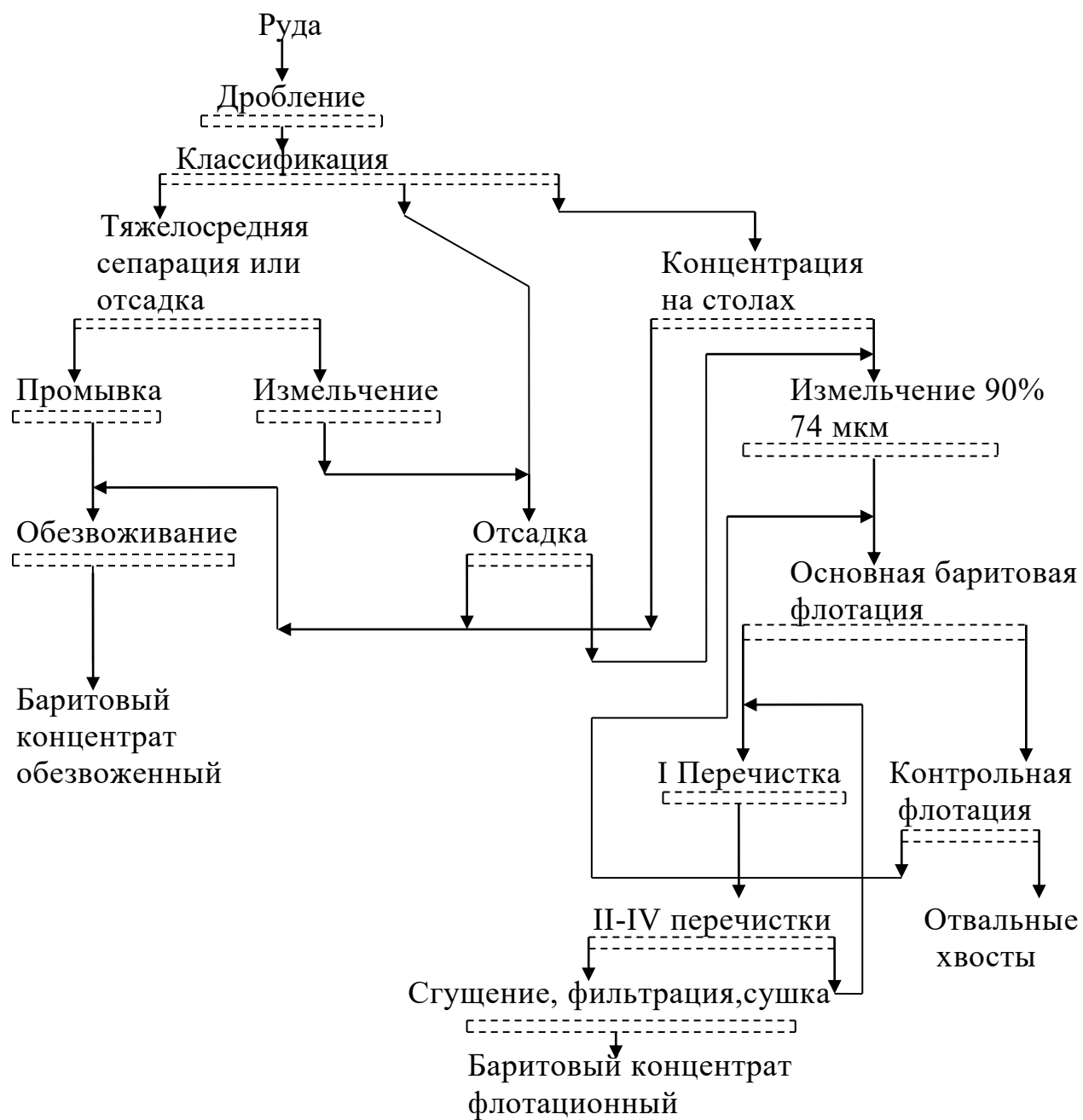
Рисунок 1 - Принципиальная схема обогащения баритовых руд
