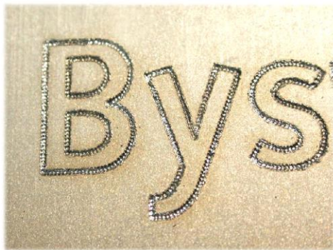
4.2 Сурет – Лазердің жоғары қуатылығына байланысты гравировканын тереңдігі
