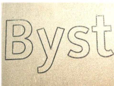
4.3 Сурет – Төмен лазерлік қуатылығына байланысты гравировканын тереңдігі
