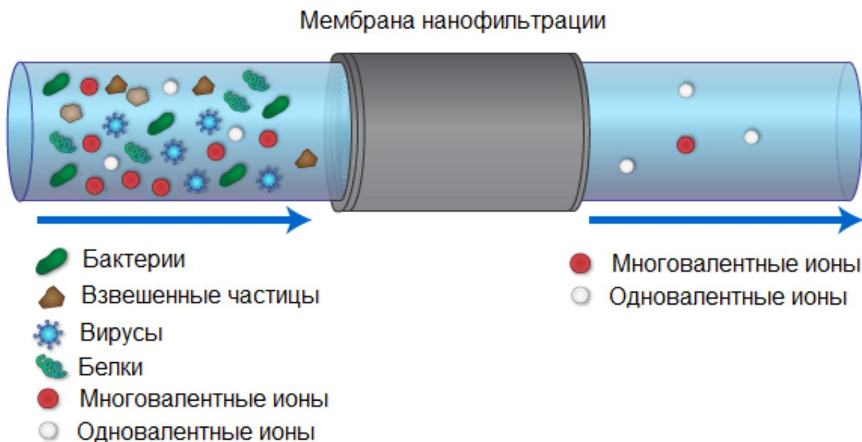
Рисунок 10 – Процесс наночильтрации
