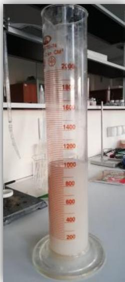
Рисунок 14 – Суспензия бентонитной глины.
