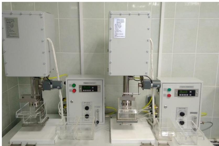
Рисунок 8 – Лабораторная флотомашина
