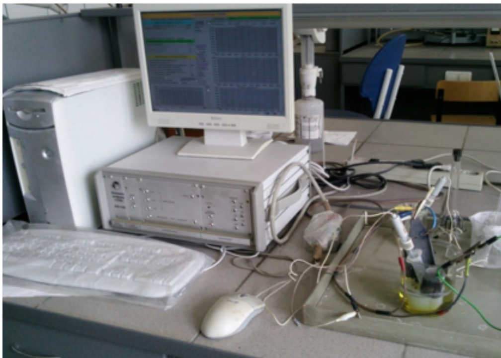
Рисунок 7 – Электрохимический комплекс ЭХК-1012
