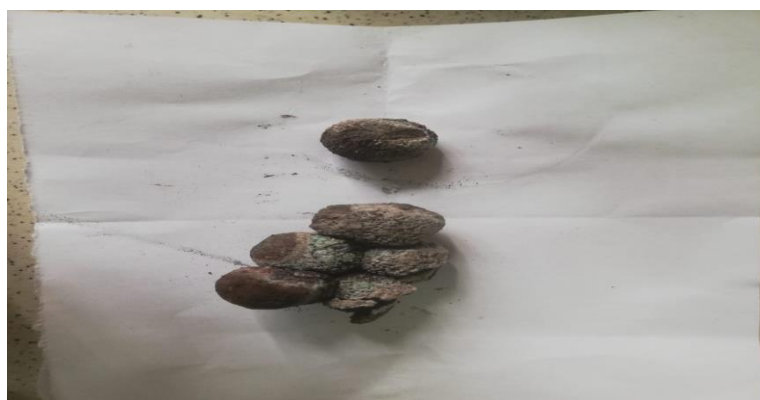
Рисунок 12 – Обожженный концентрат в реакторе фильтрующего слоя
