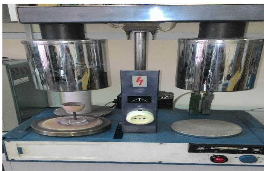
Рисунок 1 - Установка обжига ВПС
